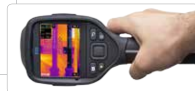
Orientamento automatico che mantiene i valori diagnostici in sovrapposizione orientati correttamente
